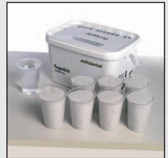
12 В случае применения сухой массы для заделки швов размешайте её точно в соответствии с прилагаемой инструкцией (7 частей массы и 1 часть воды). Последующие операции – см. рис. 13 и 14.
