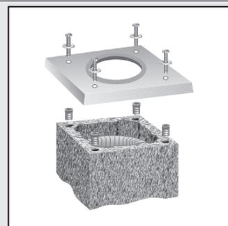
44 Подготовьте цементную подушку для установки покровной плиты, установите покровную плиту, зафиксируйте винтами.
