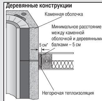
36 Расстояние от деревянных строительных конструкций должно быть не менее 5 см, расстояние от бетонных или каменных конструкций - 3 см.
