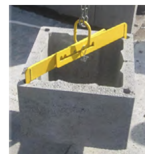
Универсальный захват для тяжелых каменных блоков
